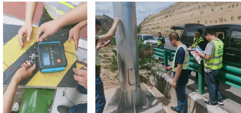
速机电工程实施交工检测。检测组各专业检测工程师，对监控、通信、收费、供配电、照明等各分项工程涉及的施工文档、施工工艺、安装技术指标、设备性能指标抽样检测。
